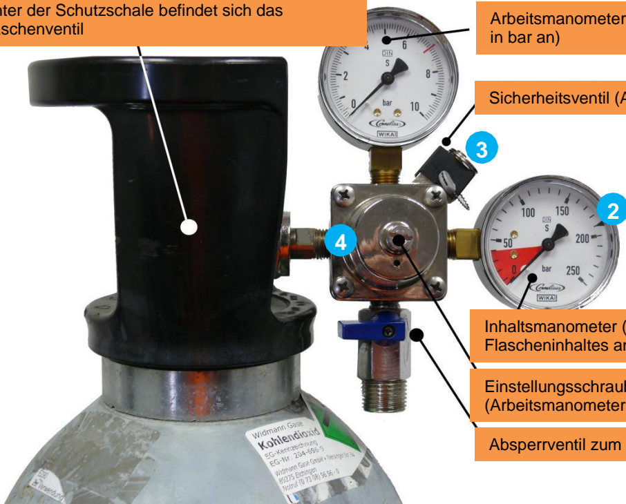
Das Inhaltsmanometer zeigt den Druck der Flasche an
