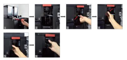
Schritt 2: Nehmen Sie die Abdeckung der Mischervorrichtung ab, entfernen Sie die Mischerschale und reinigen Sie diese mit Wasser.
