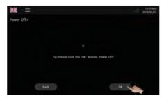
Schritt 4: Öffnen Sie im Abschaltmodus die Tür mit dem Schlüssel, drücken Sie die Netztaste und verriegeln Sie dann die Tür.
